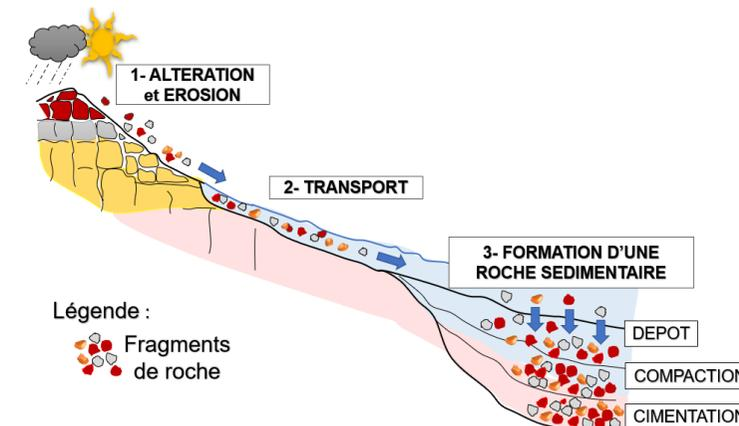
L'arkose se constitue lentement à partir des fragments qui se déposent au fond de la mer. Il se produit d'abord une compaction de ces différents fragments sous l'effet de leur accumulation, puis il se forme un ciment naturel.
